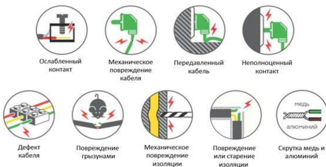
Рисунок 6. Возможные причины искрения в электропроводке
